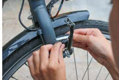
**Schritt 6:** Bremse per Hand einhängen
