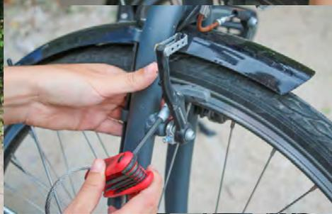
**Schritt 4:** Neuen Bremssattel unter Berücksichtigung der richtigen Reihenfolge der Distanzscheiben per Hand montieren. **Achtung:** Zunächst nur lose anbringen.
